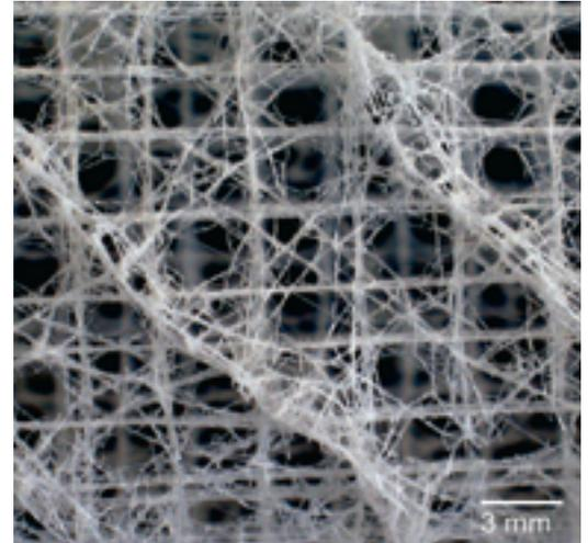
nalen Verstreubungen ausreichen, um das Fachwerk gegen Verschiebungen zu schützen.“ Zusätzlich ist die Struktur durch spiralförmige Rippen verstärkt, um ein Quetschen des Käfigaufbaus zu verhindern. „Die letzte Ebene ist die geschwungene Form des Käfigs, die sich nach unten verjüngt“, erklärt der Materialforscher. „Dort ist der Schwamm durch Glasfasern am Meeresboden verankert.“
