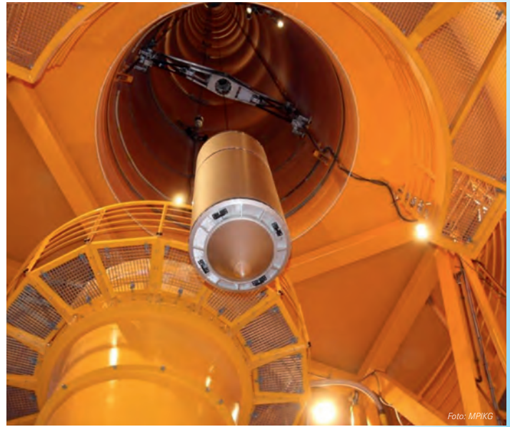
Moment, in dem die Kapsel in die Spitze des Fallturms gezogen wird.
