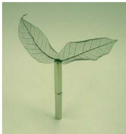
Ein magnetisches Blatt: Mit einem einfachen chemischen Verfahren lässt sich das Skelett eines Blattes in Eisenkarbid umwandeln, das magnetisch ist und den Strom leitet.
