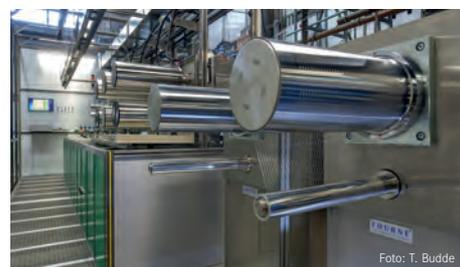
Nassspinnanlage für neue Fasern im Technikumsmaßstab
