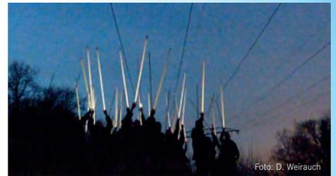
Das elektrische Feld unter der Golmer Hochspannungsfreileitung lässt Lampen aufleuchten.
